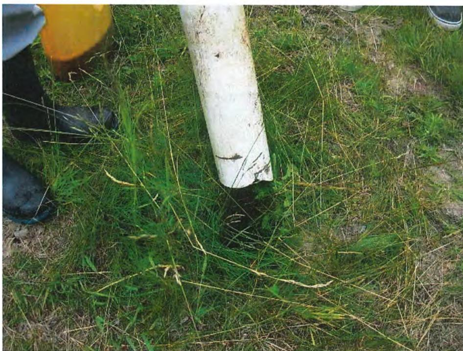
Photo 8 Installation septique 1 – piézomètre 1 s'enlevant facilement
